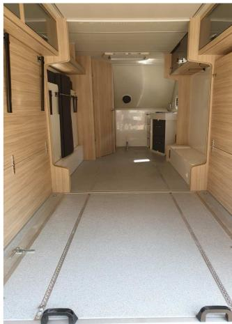
Im Innenraum werden die Betten und die Sitzgruppe mit wenigen Handgriffen hochgeklappt. Zum Verladen wird die große Heckklappe gasfederunterstützt geöffnet. Anschließend wird der Boden im Heckbereich entriegelt und abgesenkt. Dieser dient dann als Auffahrrampe.
